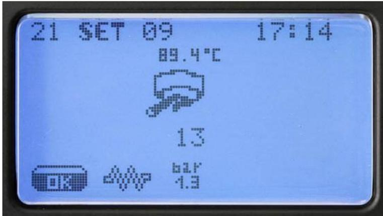
La température d'infusion est mesurée grâce à une sonde positionnée dans la partie inférieure de la chaudière et programmable par le display.
